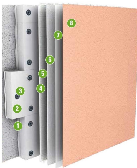
Figura 3 – Stratigrafia del sistema di isolamento termico
